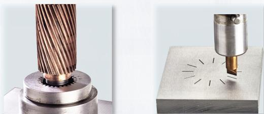
▲ 螺旋斜齒輪 & C軸定位加工
